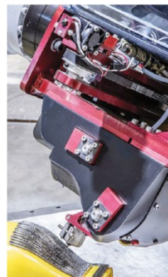
Stampante di frontiera. MasterPrint, la più grande stampante 3D mai realizzata, sviluppata dal Gruppo Camozzi: è in grado di stampare in modo additivo pezzi compositi di grandi dimensioni, fino a 16 metri di lunghezza, 2,5 di altezza e larghi oltre cinque metri
