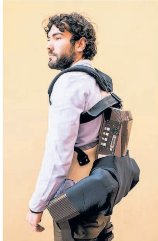
L'esoscheletro A sinistra, la versione per la riabilitazione del braccio in pazienti colpiti da ictus. A destra, il prototipo indossabile per il potenziamento motorio del bacino
