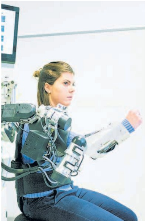
L'esoscheletro A sinistra, la versione per la riabilitazione del braccio in pazienti colpiti da ictus. A destra, il prototipo indossabile per il potenziamento motorio del bacino
